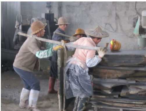
Workers are carrying stones in an ergonomic unhealthy position. 工人在不符合人体工程学健康标准的位置搬运石头。
