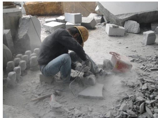
Worker is cutting in an ergonomic unhealthy position. 工人在不符合人体工程学健康标准的位置切割。
